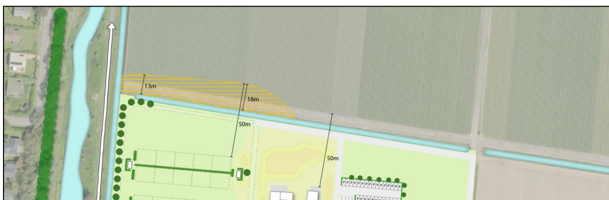
Figuur 24 | Uitsnede schetsontwerp met maatvoering tot omliggende agrarische percelen
