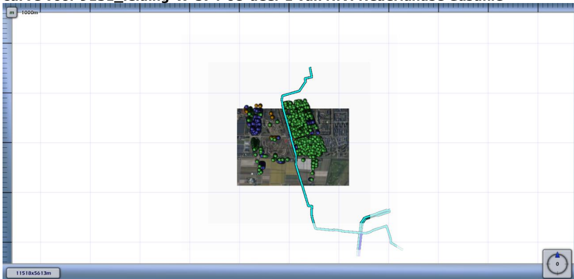
Figuur 4.5 Kilometer leiding behorende bij de maximale overschrijding van de FN-curve voor 9131_leiding-W-574-08-deel-1 van N.V. Nederlandse Gasunie
