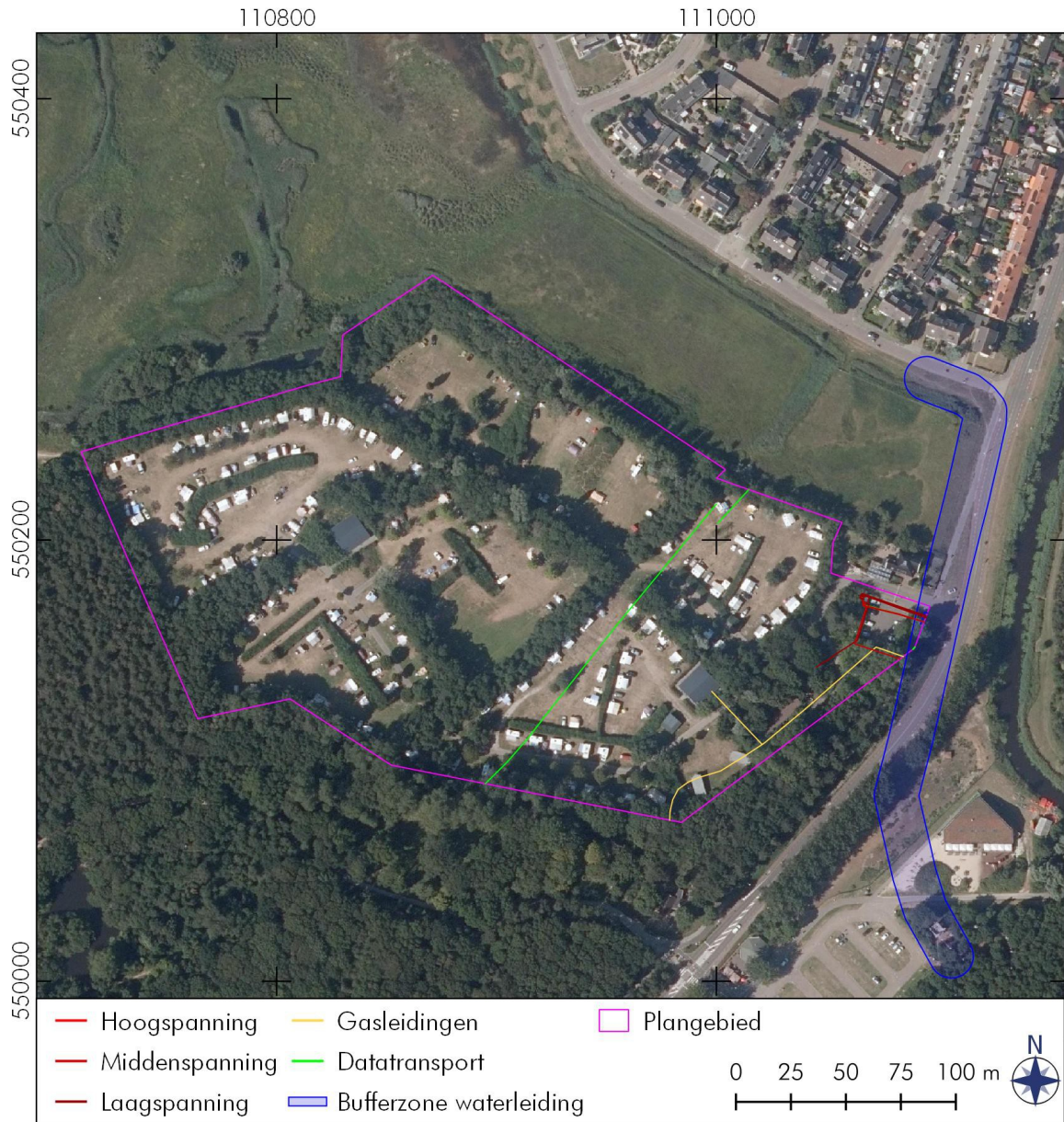
Figuur 2: Den Helder, Jan Verfaillweg 616: Luchtfoto van het plangebied (paars) met de ligging van de kabels en leidingen in het plangebied. De kabels en leidingen liggen voornamelijk in het zuidelijk deel van het plangebied. Het is echter zeer waarschijnlijk dat er ook stroom- en waterpunten nabij de kampeerplekken staan. Kabels en leidingen hiervan staan niet op de KLIC. Bron: Publieke Dienstverlening op de Kaart en KLIC-melding 21G185142.
