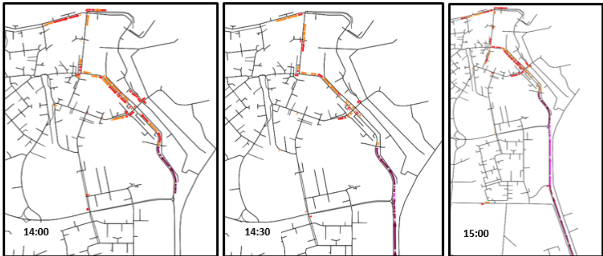
Figuur 22: Screenshots uit verkeersmodel maatregel 3, verbod op rechtsafslaan richting Van Kinsbergenbrug (vrijdag voor Pinksteren)
