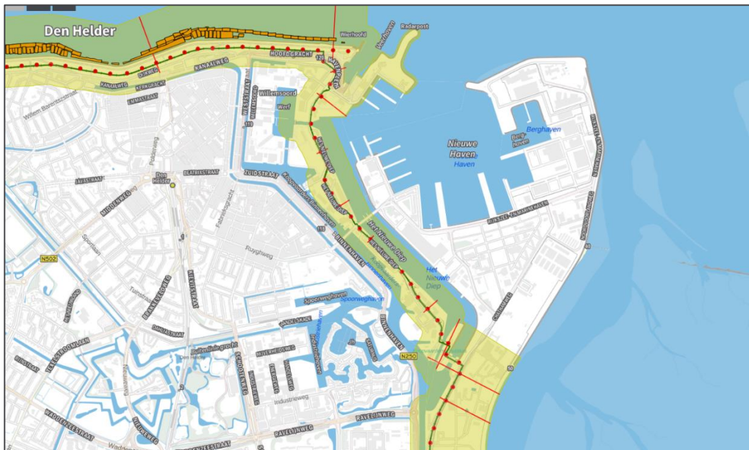
Figuur 4 Primaire waterkering (bron: HHNK)
