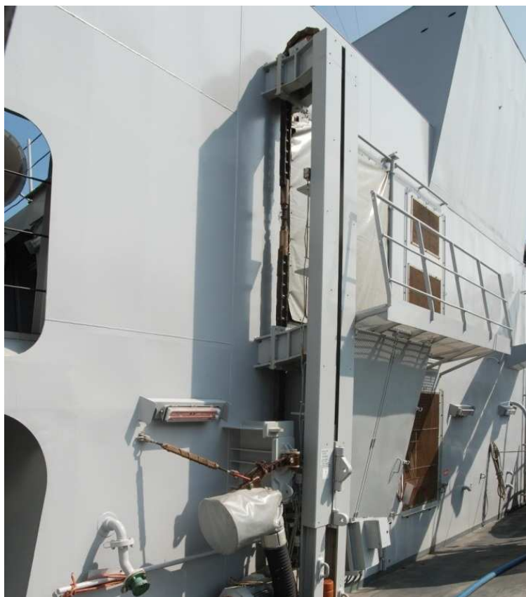
Figuur 2.5 Dekhuis met ontvangstinstallatie voor lasten en brandstoffen, Hr. Ms. De Ruyter.
