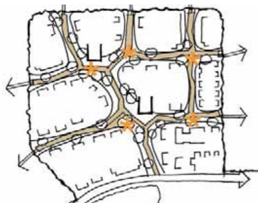
Afvalinzameling: opstelplekken langs de weg
