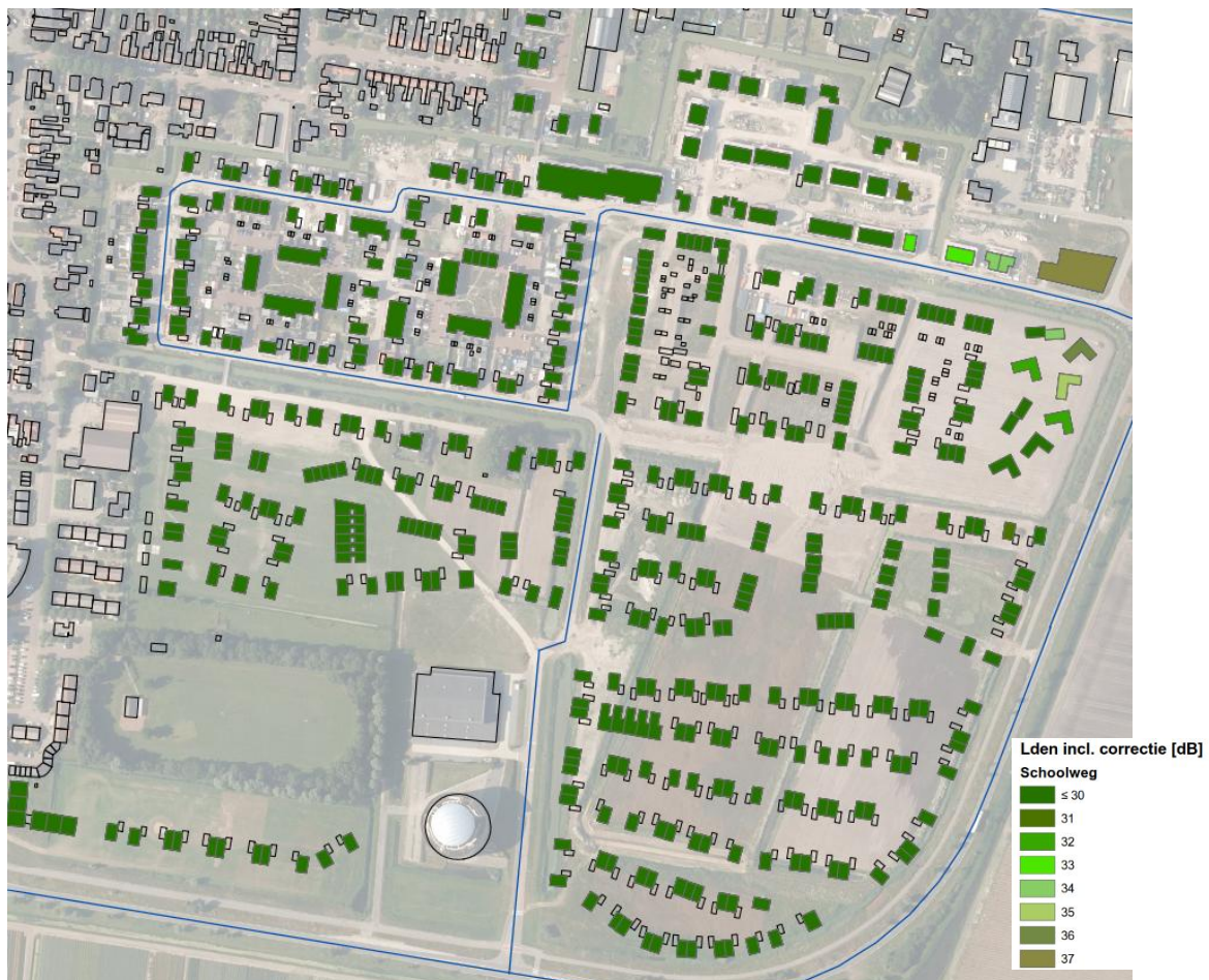
Figuur 4-1 Overzicht geluidsbelasting, L_{den} in dB, ten gevolge van wegverkeer op de Schoolweg inclusief aftrek conform artikel 3.4 uit het RMG 2012
