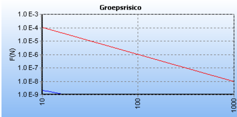
Figuur 5.2 FN curve voor A-593 van N.V. Nederlandse Gasunie voor de kilometer tussen stationing 350.00 en stationing 1350.00
