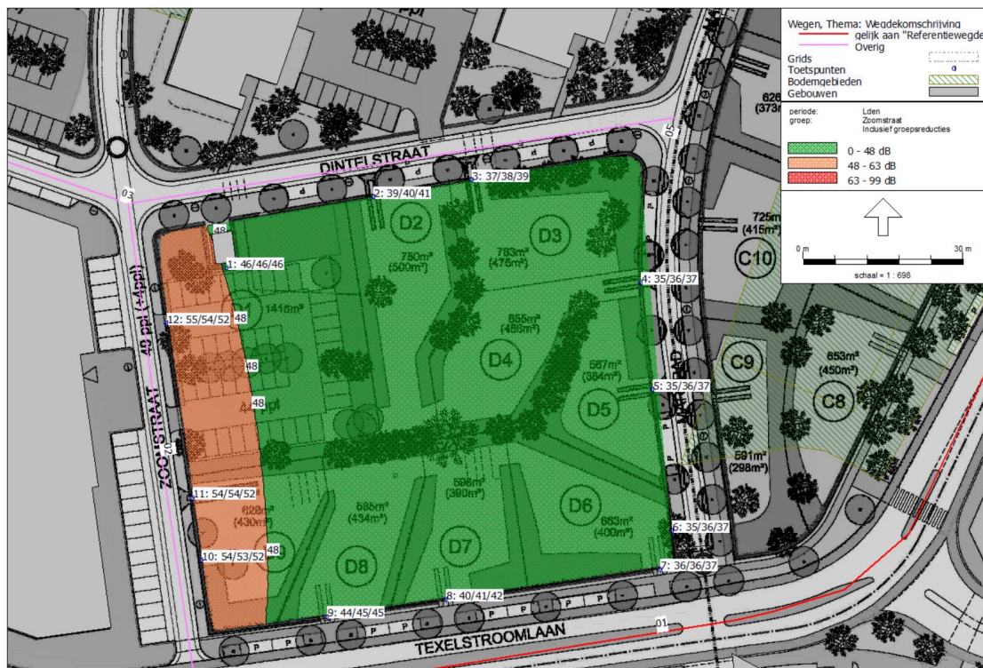
Figuur 5.2 Geluidbelasting tgv Zoomstraat binnen het plan (op 7,5 meter hoogte) op en op de plangrens op 1,5, 4,5 en 7,5 meter hoogte (inclusief aftrek art. 110g Wet geluidhinder)
