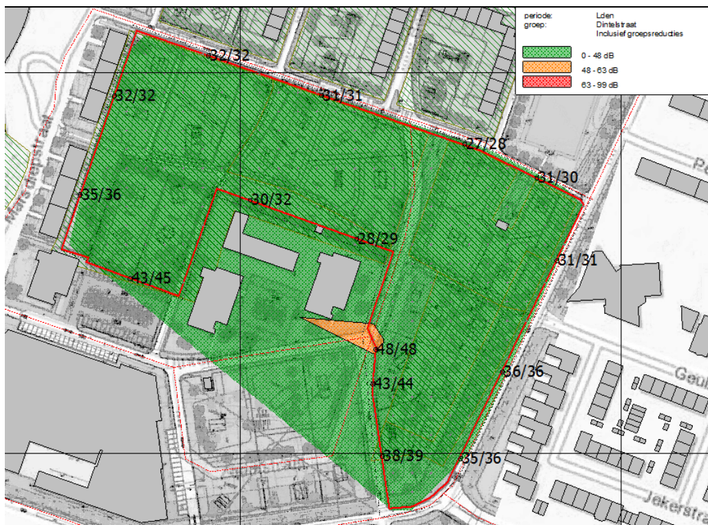
Figuur 5.4 Geluidcontour en -belasting tgv Dintelstraat en plangrens op 1,5 en 4,5 meter (incl. aftrek art. 110g Wet geluidhinder)
