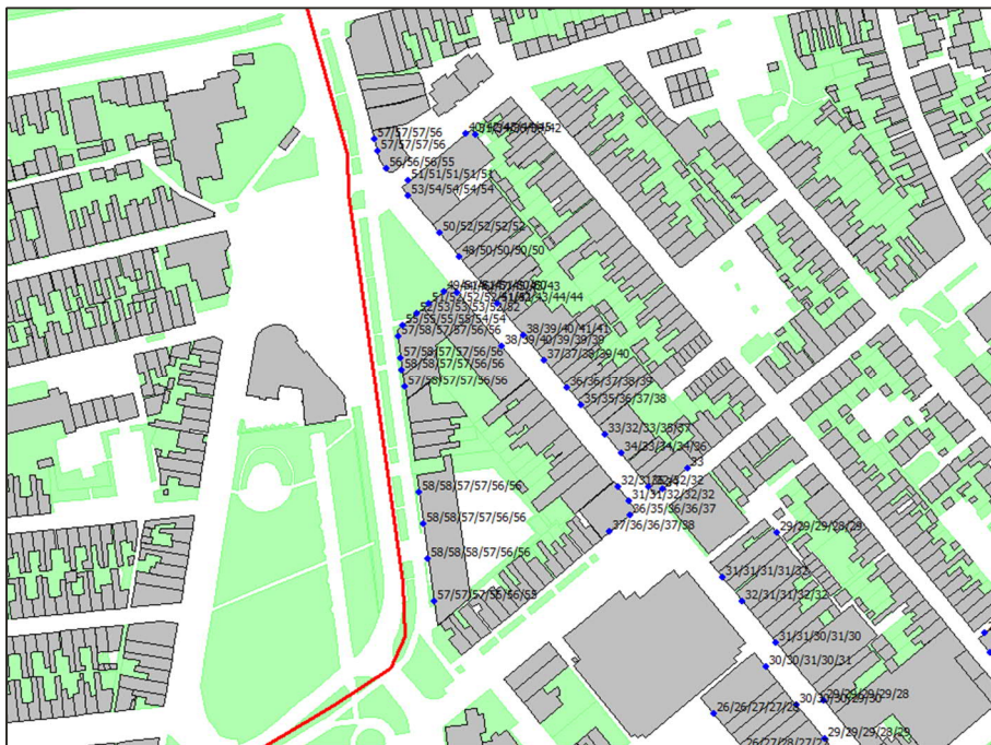
Afbeelding 3 Geluidbelastingen Koningsplein/Prins Hendriklaan/Polderweg (inclusief aftrek art. 110g Wgh) [begane grond/verdieping 1/ verdieping 2/ verdieping 3/ verdieping 4/ verdieping 5]
